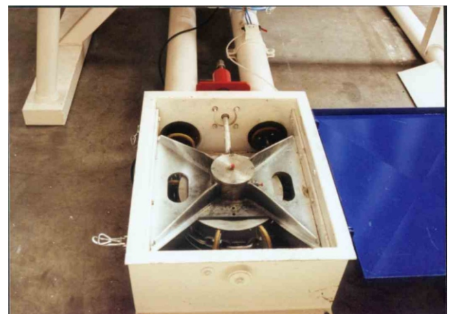
Rohrkette mit Fördertellern
