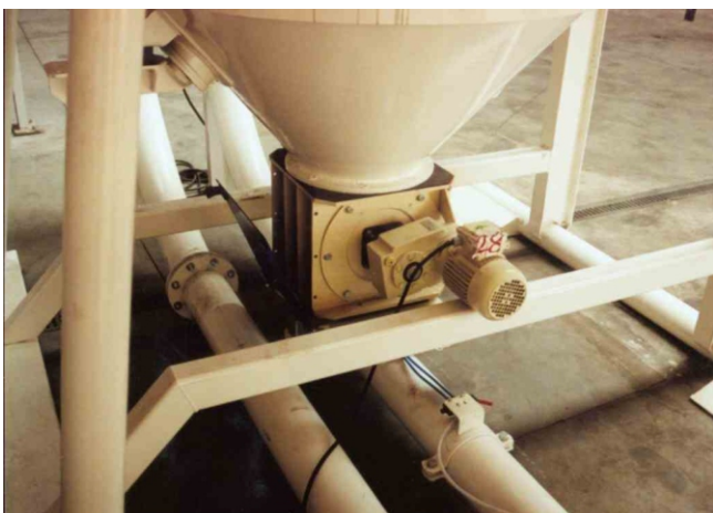
Als Dosier- und Verschlusselement dient eine Zellenradschleuse
